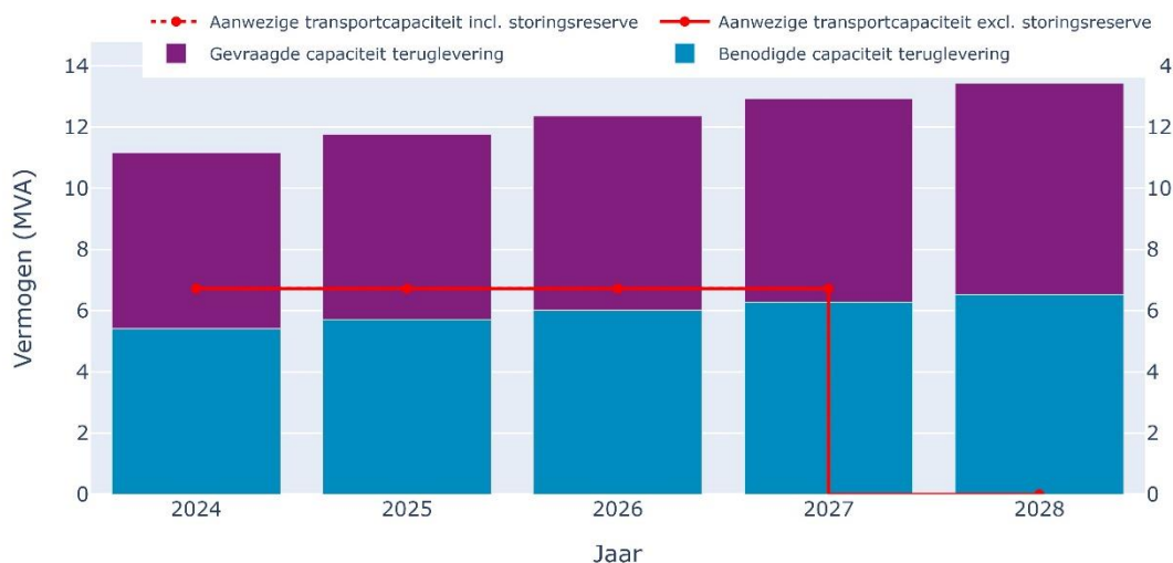
Figuur 3: Ontwikkeling van de aanwezig transportcapaciteit op congestiegebied Smeden 24A – Nagelerweg 3 - Lire tot en met het tweede kwartaal van 2027.
