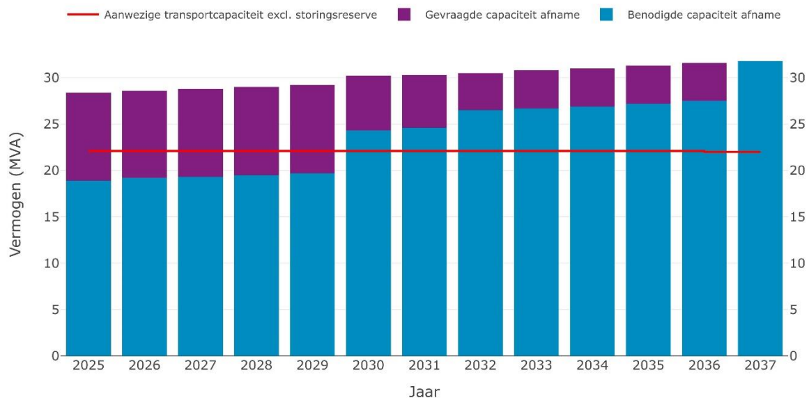
Figuur 2: ontwikkeling van de benodigde, aanwezige en gevraagde transportcapaciteit gedurende de congestieperiode.
